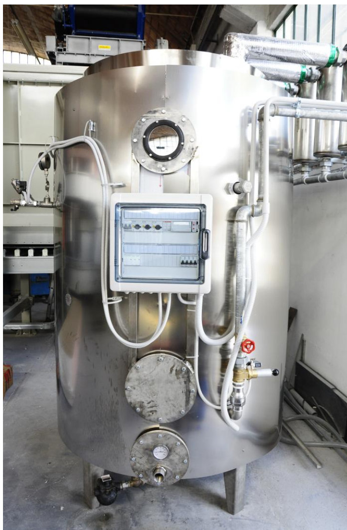
Distillatore sottovuoto. La fotografia riproduce la macchina installata presso il cliente.
