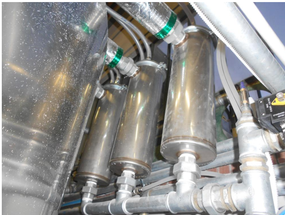
Fig.11 Foto della batteria di condensatori all'uscita dell'evaporatore
