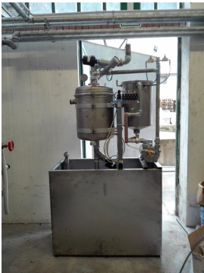
Unità di generazione del Sottovuoto installato. La fotografia riproduce la macchina installata presso il cliente.
