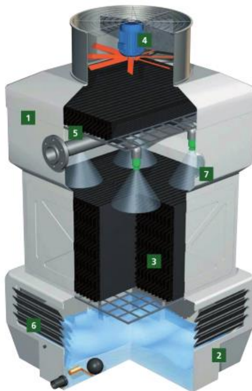
Fig.22 Foto e spaccato della torre evaporativa
