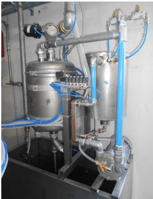
Fig.14 Foto dell'impianto per la generazione del vuoto
